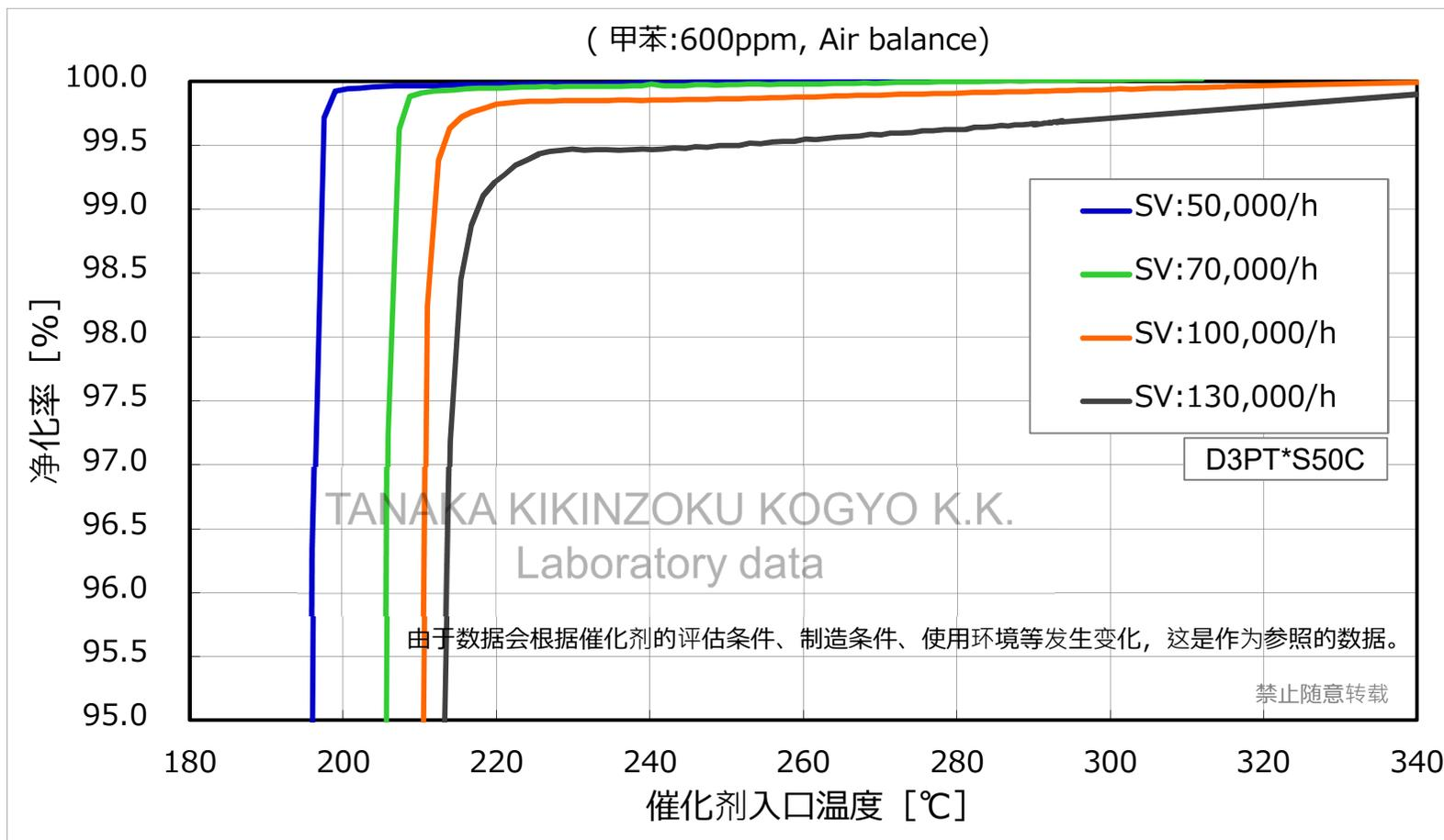
$$SV(/h) = \text{废气风量 (Nm}^3/h) / \text{催化剂量 (m}^3)$$
