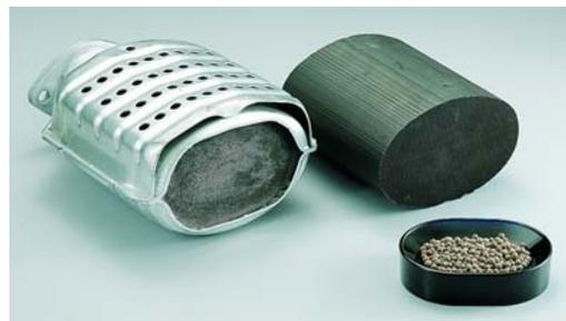
报废的汽车排气净化用触媒
