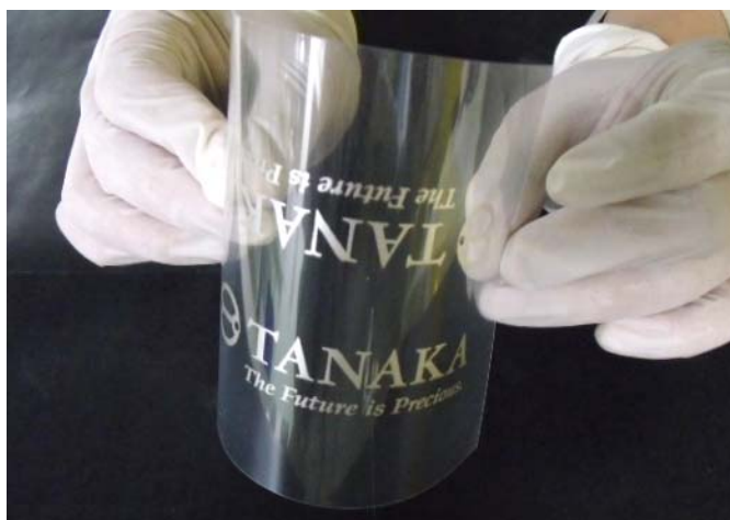
使用此次开始销售之银墨水，并以柔版印刷法制成之电子电路
