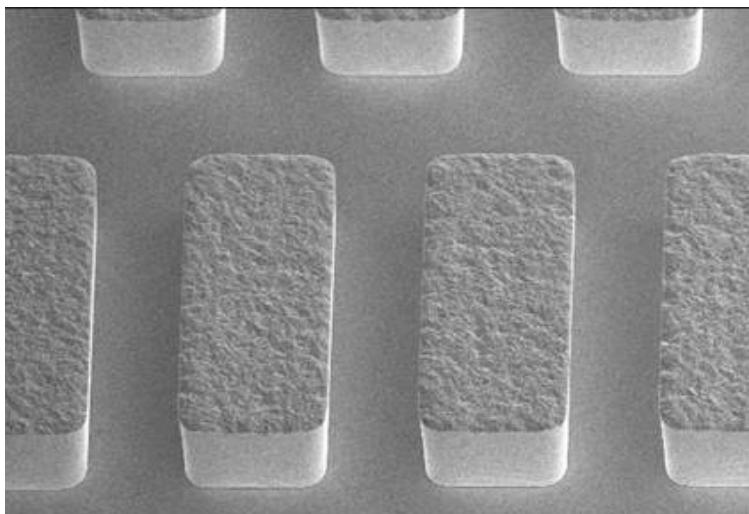
经无氟镀金液处理后的晶圆凸块形状实例（宽 30 μm）
