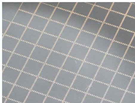
在 8 寸硅晶圆板上印制的“AuRoFUSE™”的密封外框外观（200 μm 宽）
